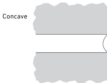
Joint de mortier recommandé 10 mm ( $\frac{3}{8}$  po)
